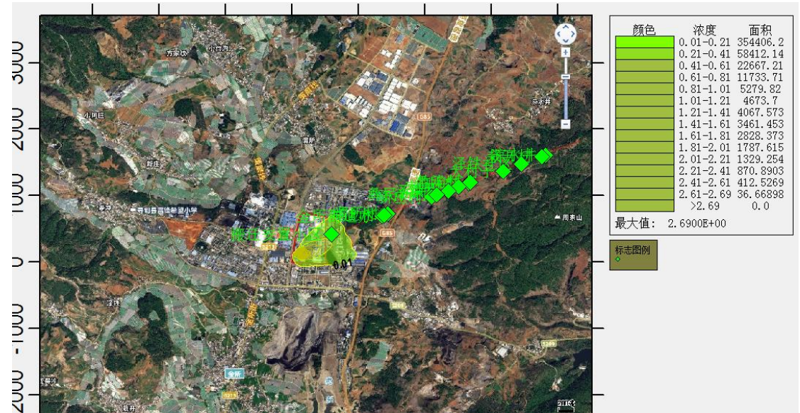
图 6.5.5-5 生产过程浓硫酸泄漏后正常气象条件下硫酸雾下风向扩散分布图
